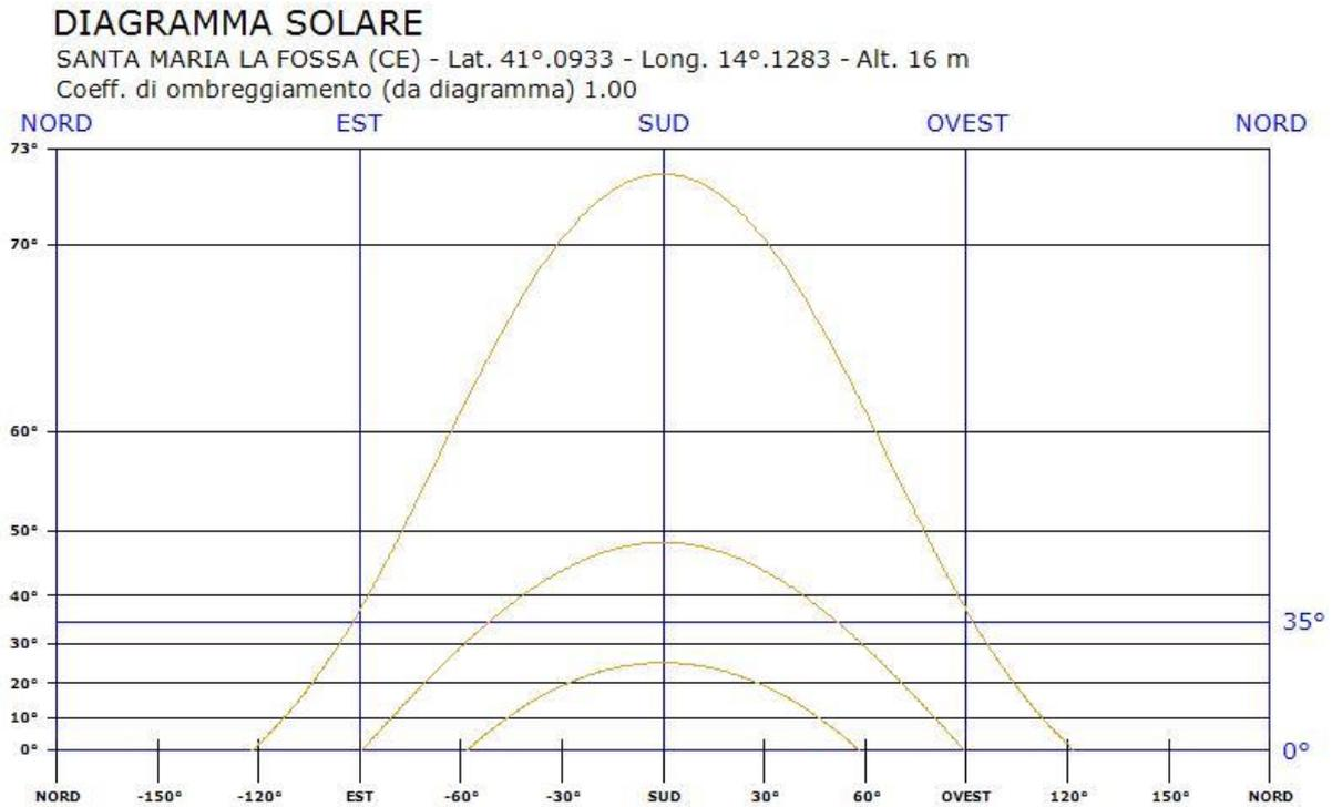
Fig. 2: Diagramma solare
